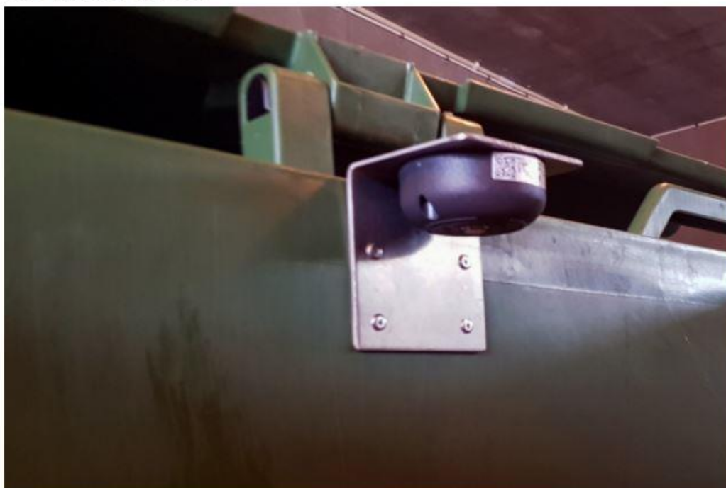
En sensor på sopkärlet ska känna av när det är dags för tömning. Foto: SSAM
